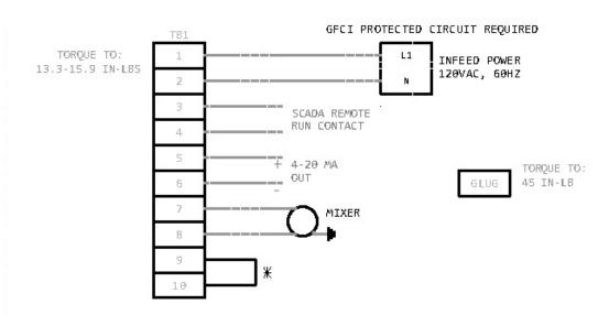
\* ONLY REMOVE FACTORY INSTALLED AUX INTERLOCK JUMPER WIRE FROM TB1:9 AND TB1:10 IF EXTERNAL DEVICE IS REQUIRED TO INHIBIT MIXER OPERATION. THE EXTERNAL INTERLOCK DEVICE (FLOAT LEVEL TANK, LEVEL CONTROLLER, REMOTE SWITCH, ETC.) MUST BE A NON POWERED DRY CONTACT (NORMALLY CLOSED) AND PROVIDE DELAY CIRCUITRY TO PREVENT MIXER SHORT/RAPID CYCLING, FAILURE TO DO SO WILL CAUSE MIXER DAMAGE AND VOID WARRANTY.
