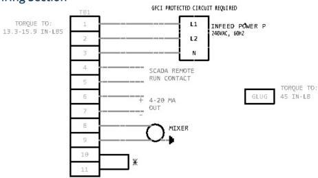
\* ONLY REMOVE FACTORY INSTALLED AUX INTERLOCK JUMPER WIRE FROM TB1:10 AND TB1:11 IF EXTERNAL DEVICE IS REQUIRED TO INHIBIT MIXER OPERATION. THE EXTERNAL INTERLOCK DEVICE (FLOAT LEVEL TANK, LEVEL CONTROLLER, REMOTE SWITCH, ETC.) MUST BE A NON POWERED DRY CONTACT (NORMALLY CLOSED) AND PROVIDE DELAY CIRCUITRY TO PREVENT MIXER SHORT/RAPID CYCLING, FAILURE TO DO SO WILL CAUSE MIXER DAMAGE AND VOID WARRANTY.
